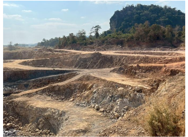
รูปที่ 2.2-2 การเปิดหน้าเหมืองในลักษณะขั้นบันได
